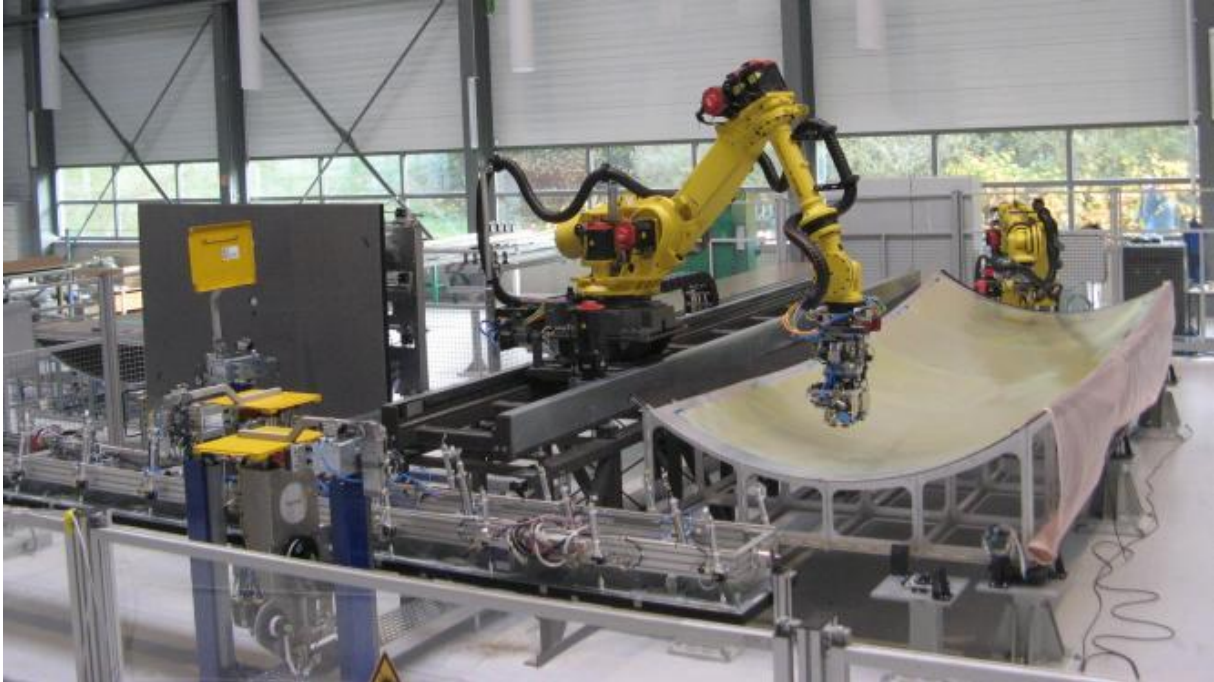
Testzelle für die automatisierte Fertigung von glasfaserverstärktem Aluminium (FML) im Technologiezentrum Nordenham
